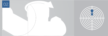
02 Bewegung des Treffmittelpunkts nach unten – den Regler des Drehknopfs der Höhenstellung gegen die „UP“ Pfeilrichtung drehen
