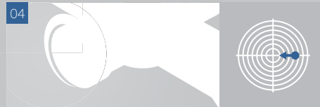
04 Bewegung des Treffmittelpunkts nach rechts – den Regler des Drehknopfs der Seitenstellung gegen die „L“ Pfeilrichtung drehen.
