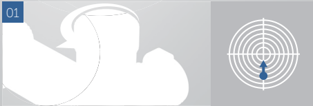
01 Bewegung des Treffmittelpunkts nach oben – den Regler des Drehknopfs der Höhenstellung in der „UP“ Pfeilrichtung drehen
